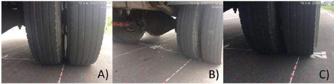
รูปที่ 8.14 ตำแหน่งกตัทับของลื้อรถบรรทุกบน Strain Gage ดังนี้ A) กึ่งกลางระหว่างลื้อคู่ B) ใต้ลื้อด้านใน C) ใต้ลื้อด้านนอก
