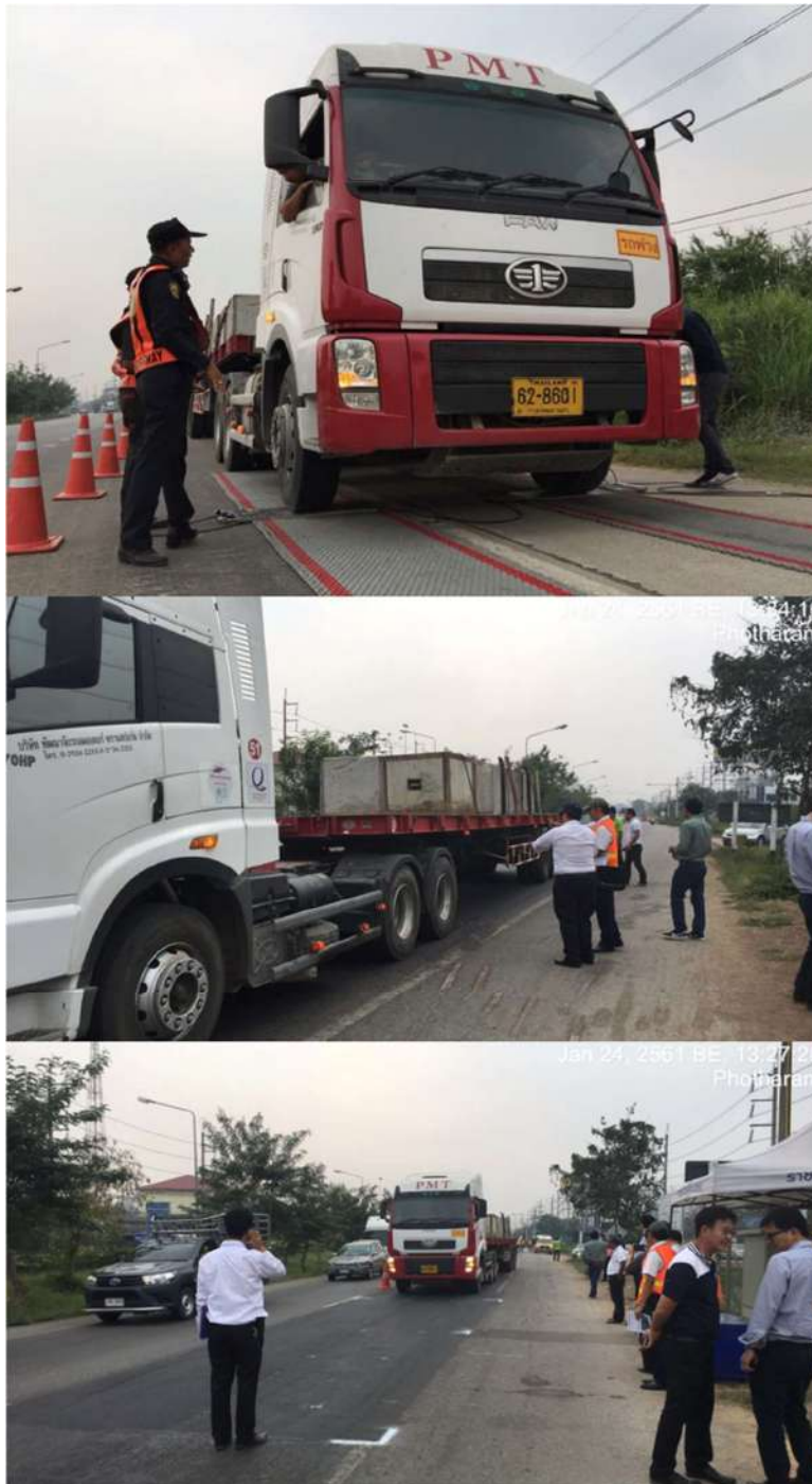
รูปที่ 7.2 การทดสอบรถกึ่งพ่วง 6 เพลา 22 ล้อ พิกัดน้ำหนักบรรทุก 50.5 ตัน ในวันที่ 24 ม.ค. 2561
