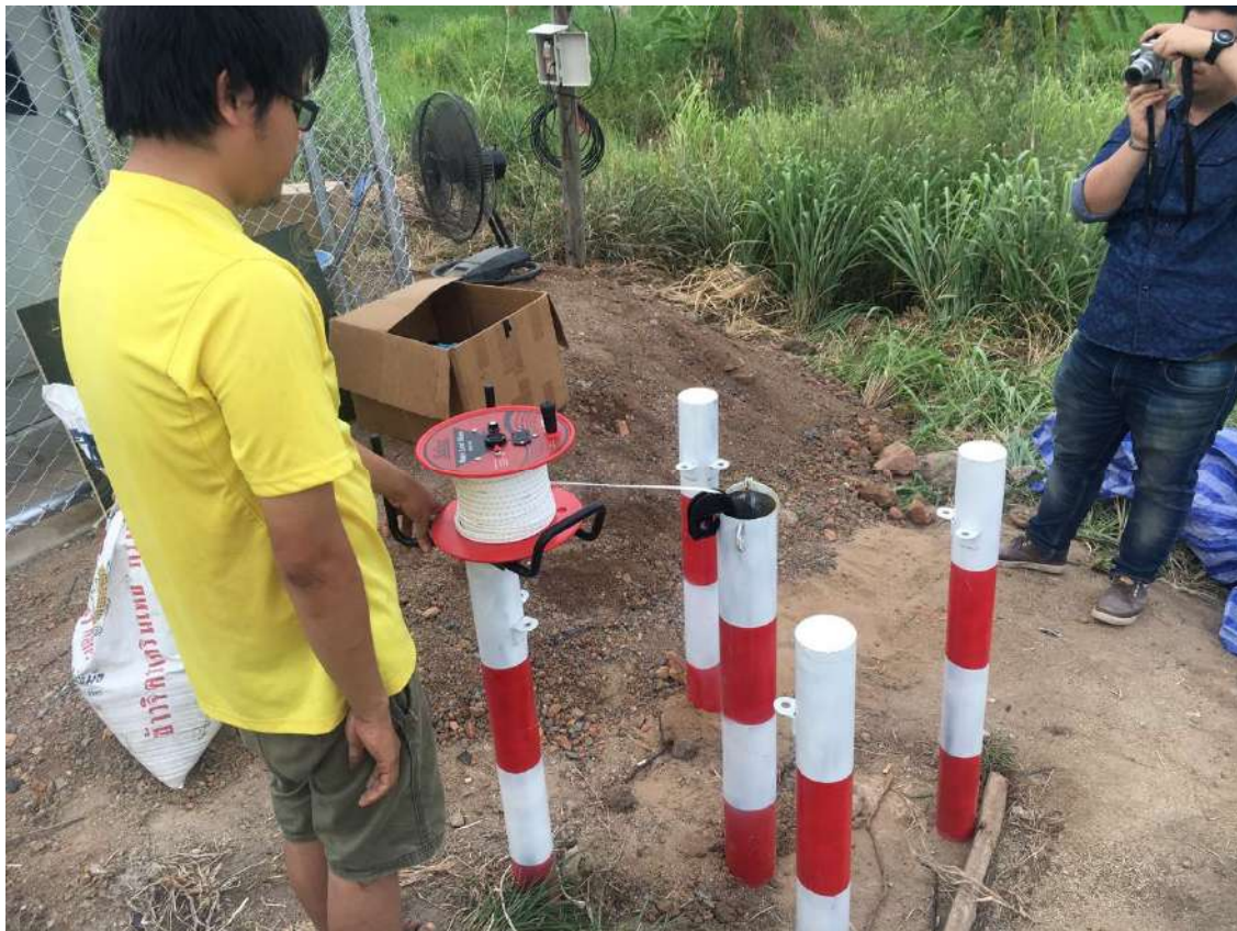
รูปที่ 5.162 การทดสอบอุปกรณ์ตรวจวัดระดับน้ำในหลุมเจาะ (Observation Well)
