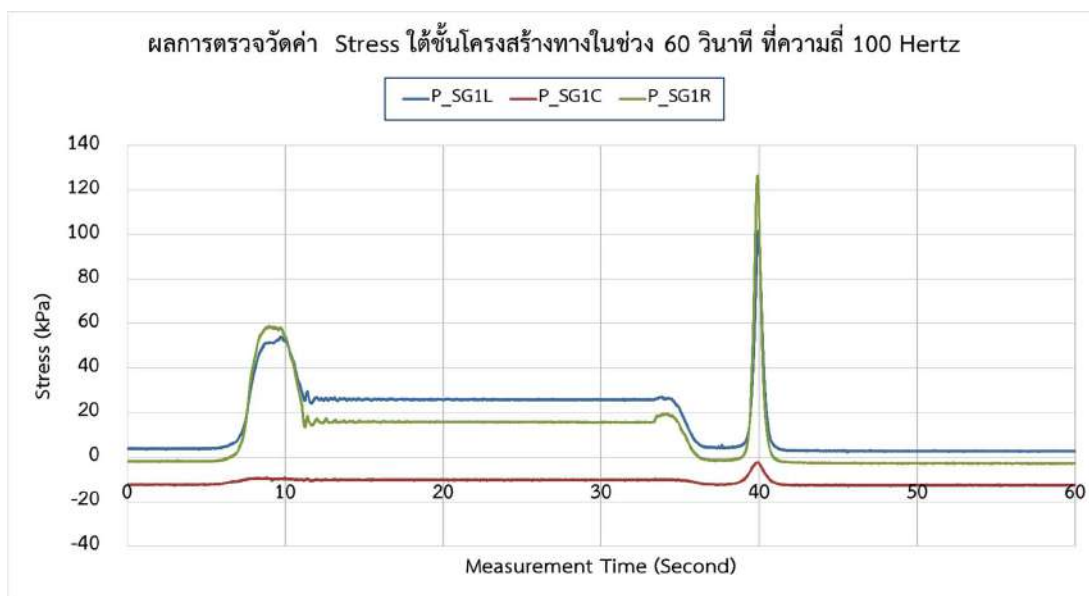
รูปที่ 10.1 ความเค้น กรณีรถหุยนต์หนึ่งรถ 6 ล้อ พิกัดบรรทุกทุก 100% แบบหุยนต์หนึ่ง เพลาหน้า น้ำหนัก 3.94 ตัน อุปกรณ์ Pressure Cell ชั้น Top Subgrade (60 cm) แกวที่ 1
