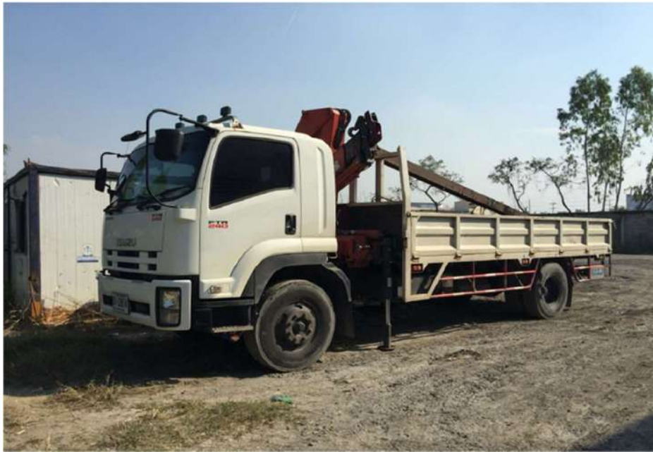
รูปที่ 7.4 รถบรรทุกซึ่งใช้ในการทดสอบรถ 2 เพลา 6 ล้อ พิกัดน้ำหนักบรรทุก 15 ตัน
